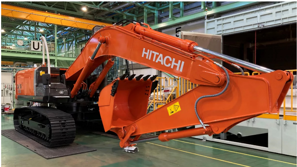
Figuur 4.3: Hitachi graafmachine, onbruikbaar ('obsolete') geraakt na overstromingen in Japan in 2018, geremanufactured naar nieuw en verkocht met garantie als 'Premium Used'. (Bron beeldmateriaal: https://www.hitachicm.com/global/en/products/remanufactured/projects/ )
