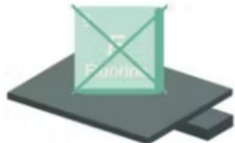
M3A: Fluorvrij zonnepaneel (ZZS-vrij backsheet)
