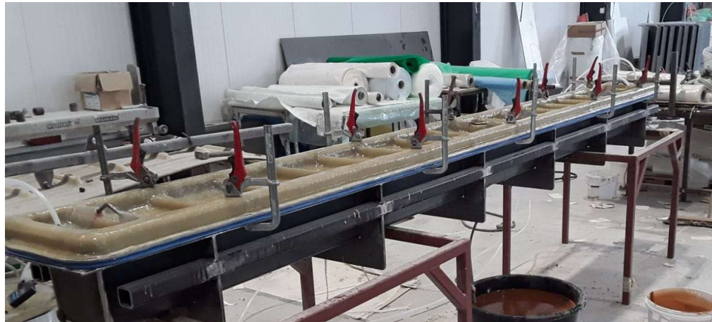
Vervaardiging met RTM-techniek
