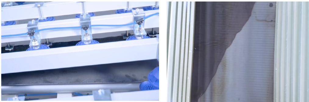
Stap 3 en 4: Glasplaten gecontroleerd uit elkaar trekken, platen in chemisch bad plaatsen om halgeleiderlagen op te lossen, metaalfractionen (zoals Cd, Te) uit de oplossing terugwinnen
