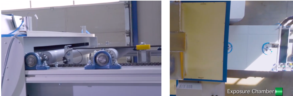
Stap 2: Paneel op rolband plaatsen en belichten in laserkamer, zodat hechting minder sterk wordt
